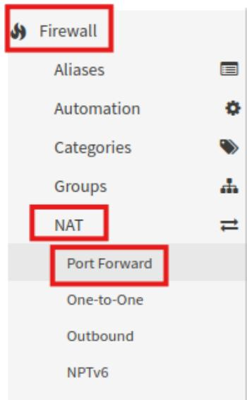
Pour mettre en place la redirection de port qui va permettre d'accéder au contenu du serveur WEB depuis le WAN, on va se rendre dans la section FireWall de l'OPNsense, puis NAT → Port Forward. Ensuite, cliquer sur le + pour ajouter une redirection de port.
