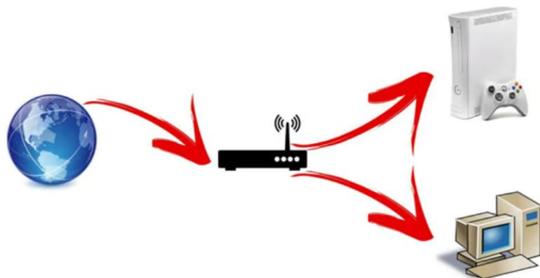
Le Port Forwarding, aussi appelé redirection de port, est une technique de configuration d'un routeur ou d'un pare-feu. Elle consiste à diriger le trafic entrant reçu sur un port précis de l'adresse publique (WAN) du réseau vers un appareil spécifique du réseau local (LAN). Par exemple, si un routeur reçoit des données sur le port 80, il peut les rediriger vers un ordinateur interne qui héberge un site web, comme on va le mettre en place dans le cas qui va suivre.
